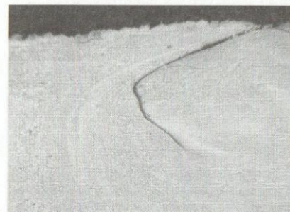
Obr. 12 zv. 100x Rozvoj porušení, řízený plastickým tokem materiálu
