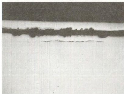
Obr. 10 zv. 50x Podpovrchová iniciace kontaktně-únavového porušení
