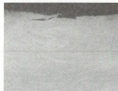
Obr. 6 zv. 100x Mikrotrhlin, iniciovaná na nerovnostech, vyvolaných plastickou deformací povrchu
