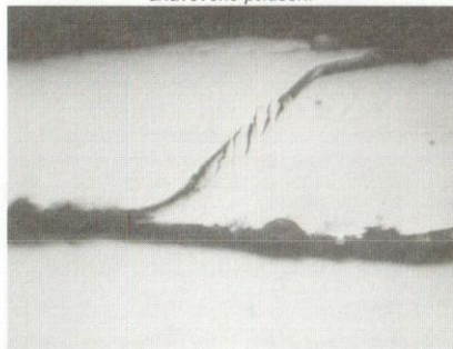
Obr. 11 zv. 250x Střihový mechanismus oddělování silně zplastizovaných vrstev
