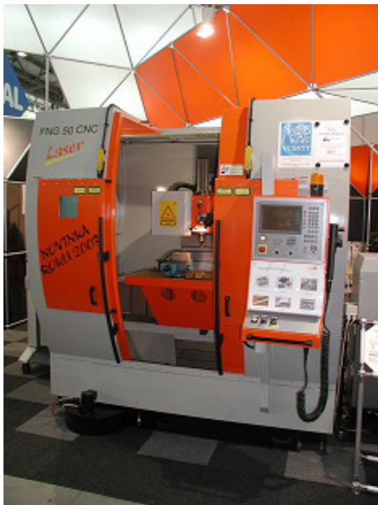
Nástrojařská frézka FNG 50 CNC s vestavěným laserem pro mikrofrézování
