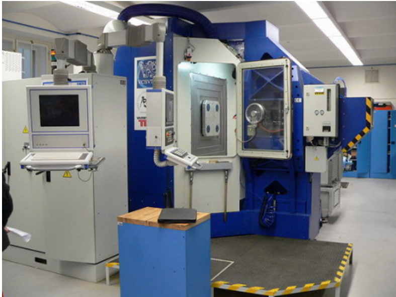
Experimentální stroj LM 2 - použity speciální lineární motory pro pohon řízených os
