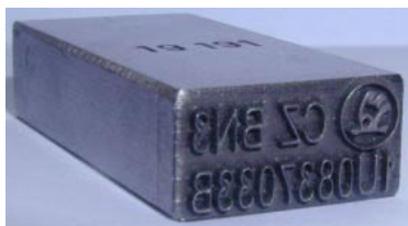
Obr.3 Příklad razníku(velikost razníku: 18x9x36 mm)
