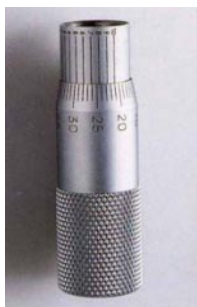
Obr.5 Příklad razníku(velikost razníku: ř3 mm)
