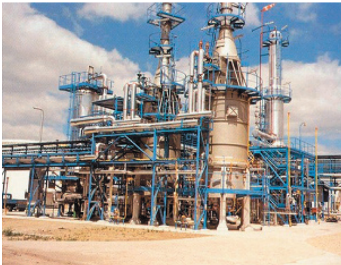
Obr.2 Fluidní katalytický krak (FCC), Česká rafinérská a.s.
