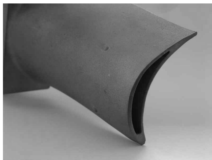
Příklad odlitky vyrobené technologií přesného lití na vytavitelný model (lopatka plynové turbíny vyrobená z niklové superslitiny)
