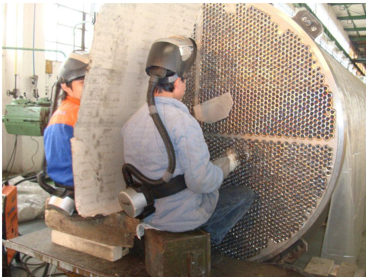
Vaření trubek výměníku
