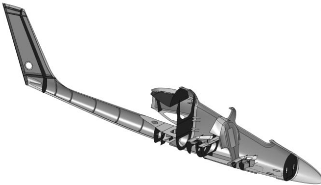
Obr. 5: Základní dokumentace trupu – 3D master model trupu
