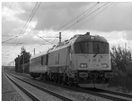
Obr. 3 Lokomotiva 380.006 vybavená měrnými dvojkolímí při zkušebních jízdách u Svitav v září 2010 (Foto: L. Veselý)
