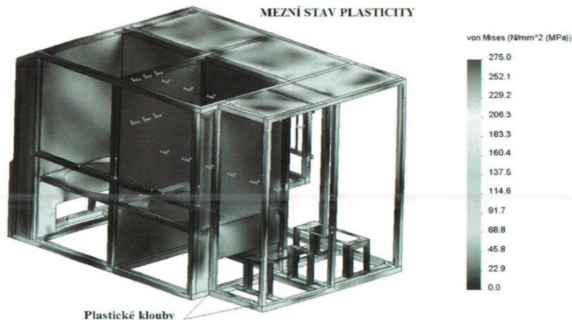
Obr. 9 Redukované napětí Mises – mezní stav plasticity
