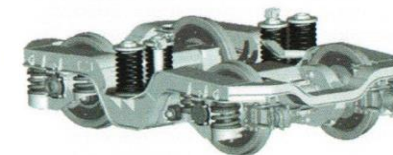
Obr. 1 Model dvou- nápravového podvozku lokomotivy řady 744.0 CZ LOKO
