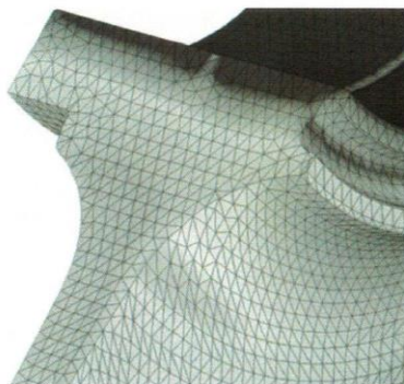
Obr. 1 Oblast vzniku maximální hodnoty redukovaného napětí \sigma_{red\ max} v zatěžovacím stavu II
