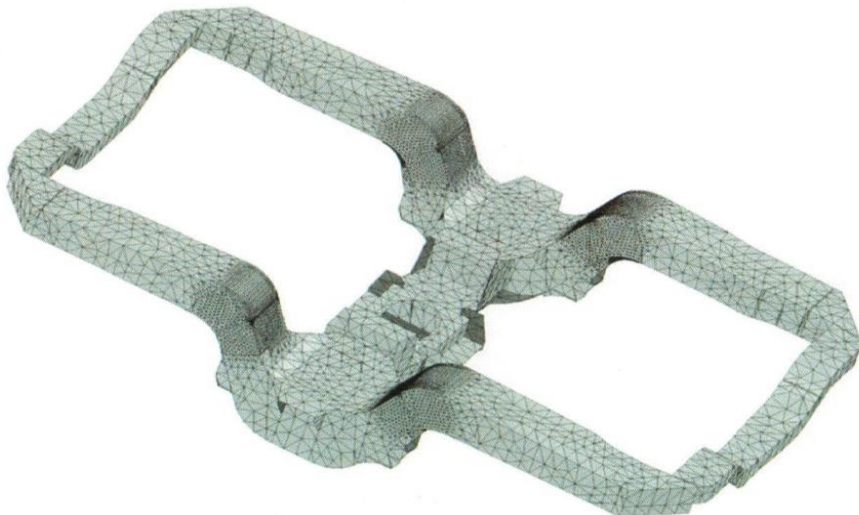
Obr. 3 Rozdělení zjednodušeného modelu rámu podvozku na trojúhelníkové deskové prvky
