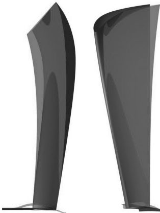
Obr. 8 – Porovnání referenčního a finálního tvaru Meridiální pohled a) Axialní pohled
