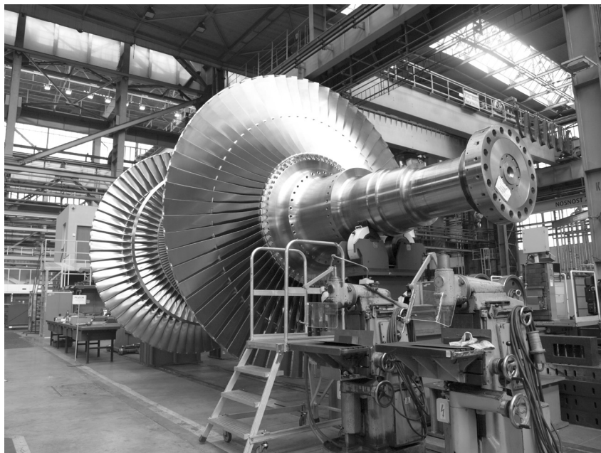
Rotor pro turbínu 270MW pro paroplynovou elektrárnu Počerady vyrobila Škoda Power
