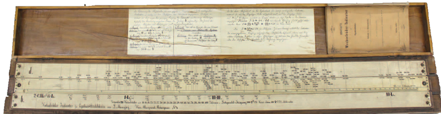
Logaritmické pravítko pro výpočet převodu pro stroj na výrobu závitů (část nejstarší dochované investice FS ČVUT z roku 1865)
