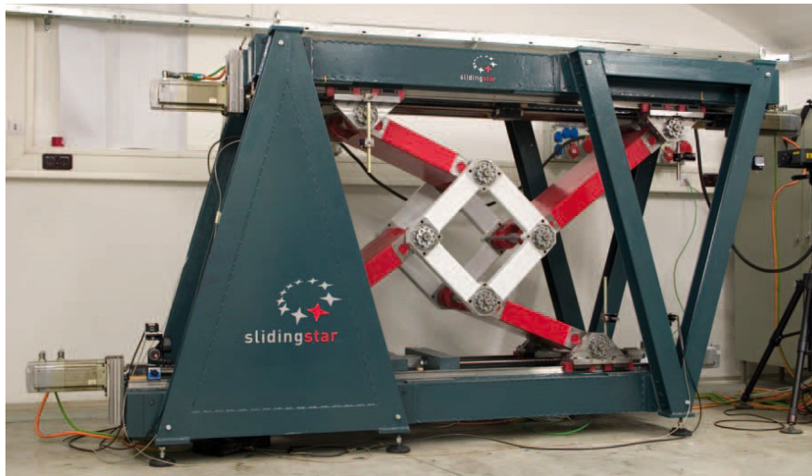
Mechanismus s paralelní kinematickou strukturou (patent FS ČVUT v Praze)
