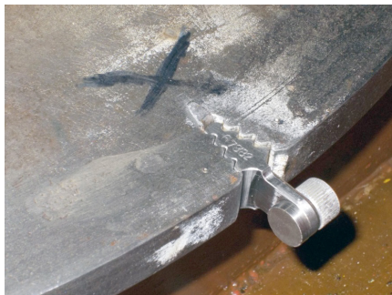
Obr. 32: Pohled na otevřený erozní stand a zkoušený vzorek při měření erozní odolnosti titanu
