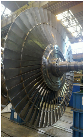
Obr. 18. Oběžné kolo s lopatkami z titanové slitiny o délce 1375 mm.
