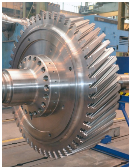
Obr. 25: Testovací rotor pro titanovou oběžnou lopatku 1375 s přímým stroměčkovým závěsem
