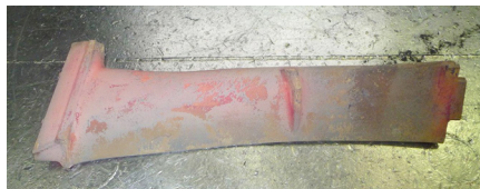
Obr. 3: Výkovek titanové lopatky 1375 mm (foto Böhler)
