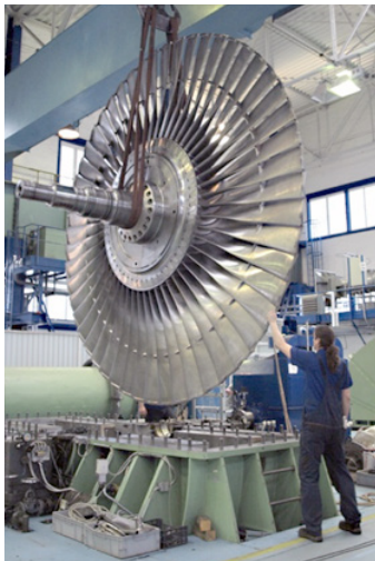
Obr. 27: Uložení rotoru Campbellově stroji
