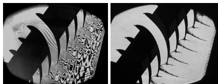
Obr. 20: Interferogram a šlíry na patě M_{2z} = 1,025 (Indie 800 MW)
