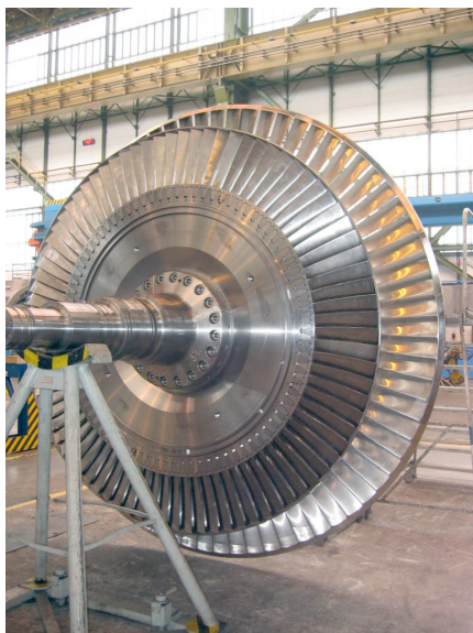
Obr. 36: Testovací rotor Campbell s oběžnými koly posledních dvou stupňů
