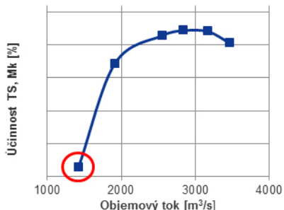
Obr. 10: Termodynamická účinnost bez využití výstupní rychlosti posledního stupně s difuzorem
