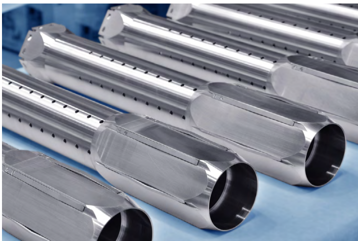
Pro belgický výzkumný reaktor BR2, jeden z nejnáročnějších výzkumných reaktorů světa, vyrobila ŠKODA JS a.s. novou vnitřní vestavbu. Celkem bylo belgické firmě SCK•CEN dodáno 158 hlavních a dalších několik stovek menších dílů z nerezavějící oceli.
