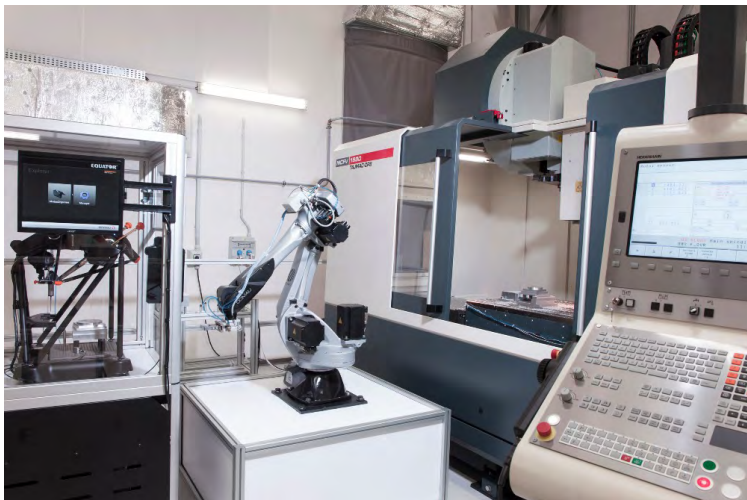
Obr. 2 Umístění robota mezi obráběcím centrem a měřícím pracovištěm výrobní buňky (foto Intamac)
