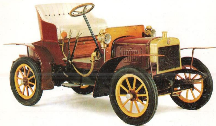
Voiturette, typ W, rok výroby 1906, dvouválec do V kapalinou chlazený, objem 1005 ccm, výkon 7 HP, max. rychlost 40 km/h
