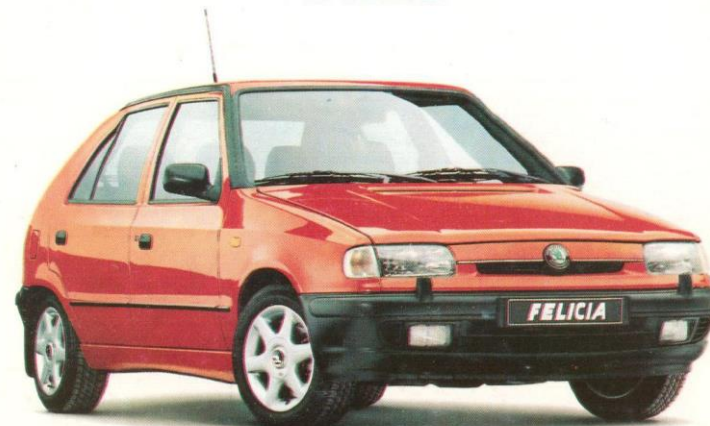
ŠKODA FELICIA vyráběná od roku 1994, čtyřválec OHV kapalinou chlazený, objem 1289 ccm, výkon 40 - 50 kW, max. rychlost 150 km/h
